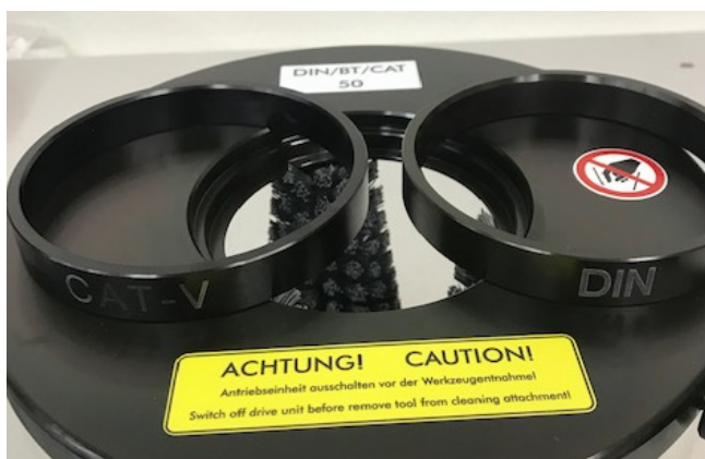
DIN/BT/CAT 50 mit Reduktionen DIN/BT/CAT 50 with reduction rings
